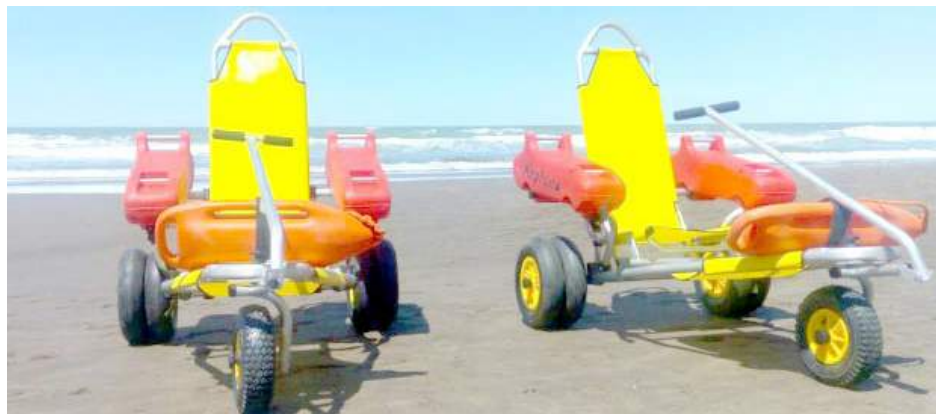
Las sillas anfibias son de aluminio, montado en ejes de acero inoxidable; posee ruedas neumáticas, flotadores de PVC inyectado. Foto Todo Provincial/InfoGEI
