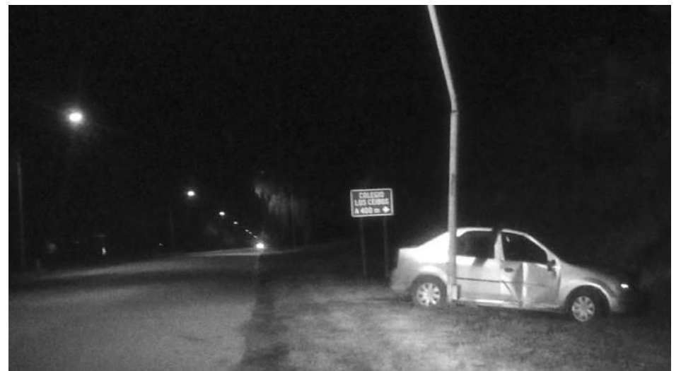
En las tomas fotográficas se pueden observar los daños ocasionados al vehículo y a la columna de luz. Fotos De Sogos.
