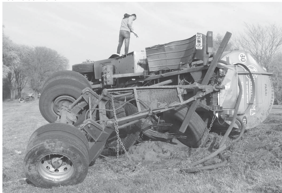
El chasis y el balancín del camión después del fuerte impacto que terminó en vuelco.
