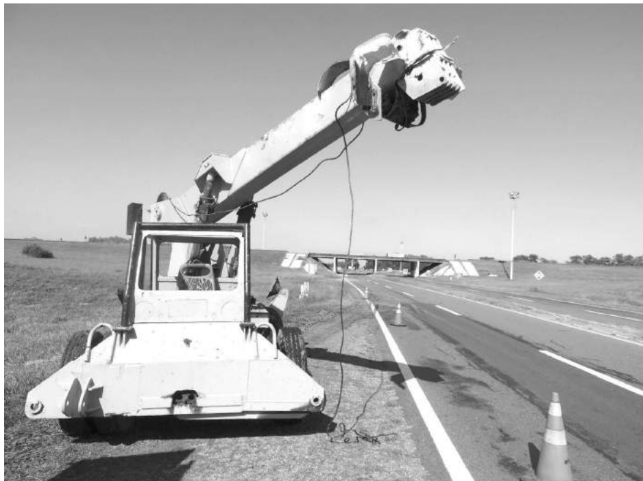
El brazo de la pluma destrozado tras el impacto contra el puente.
