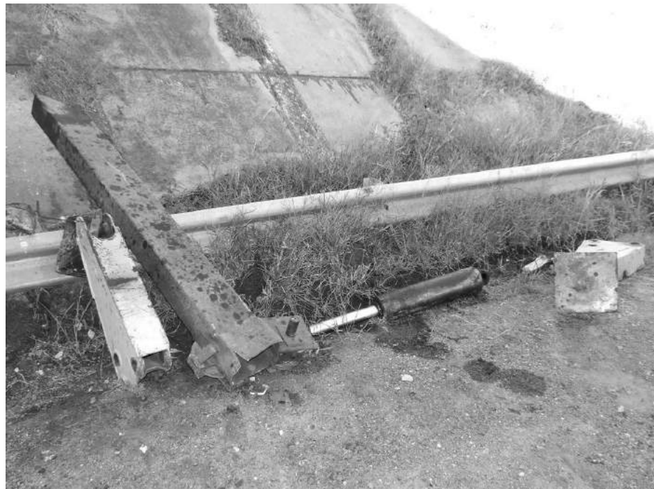
Partes del sistema hidráulico de la máquina tras el violento choque.
